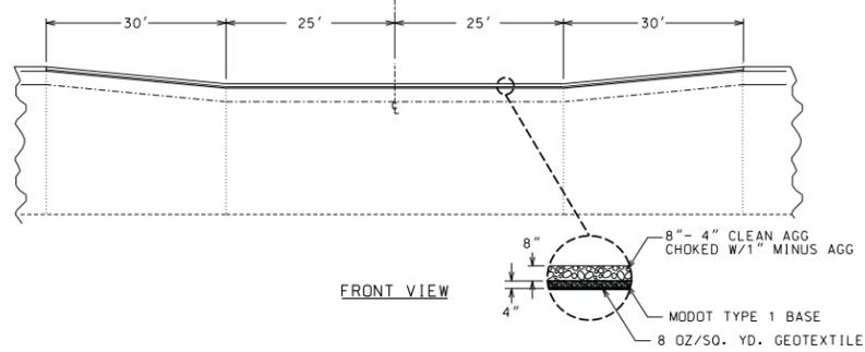
FLY ASH POND EMERGENCY SPILLWAY DETAIL
